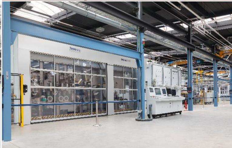
Die Pilotanlagen von Voith und Trützschler bieten zusammen eine umfassende Möglichkeit, Endprodukte vor einem Umbau zu testen.
