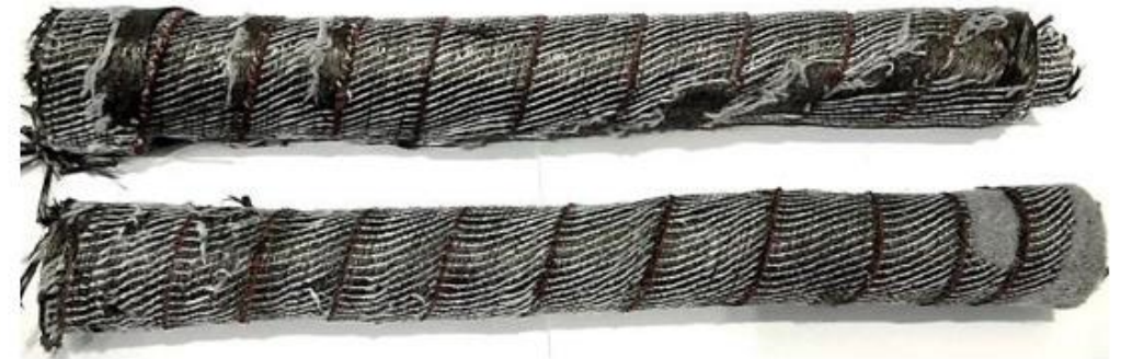
Oben: NCF auf konischem Dorn vernadelt unten: NCF auf zylindrischen Dorn vernadelt, Foto: ifm
