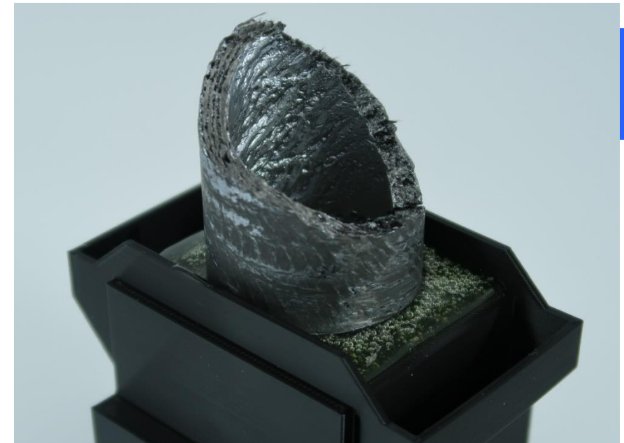
Bruchbild der zuggeprüften C/C-SiC-Rohre in Prüfform, Foto: ifm
