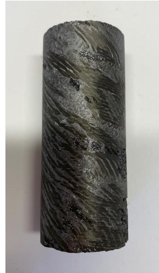
C/C-SiC-Rohr, Foto: ECM
