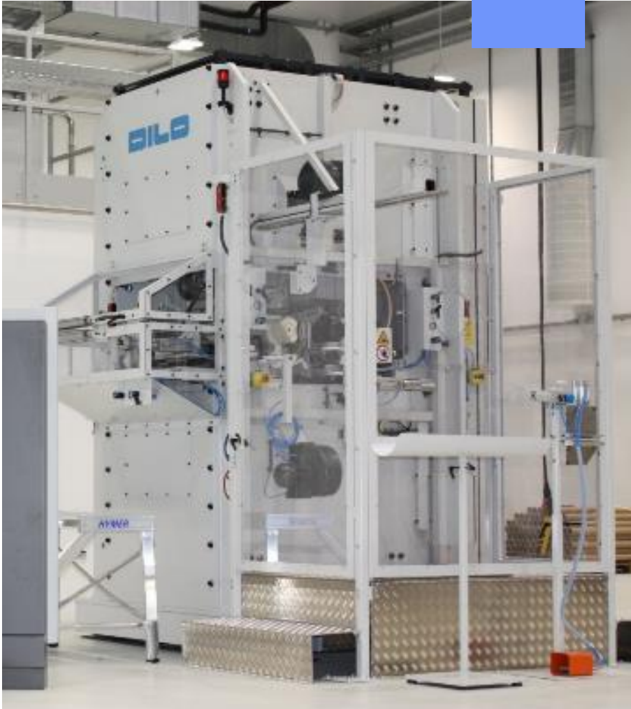
DILO Rontex S 4000 Rundvernadelungsanlage beim IFM
