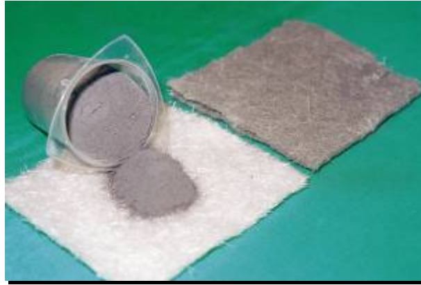
Imprägnierung mit Fibroline
